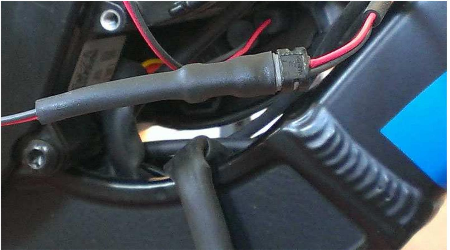
Inserire il connettore di SpeedUp nella sede rimasta vuota nel motore Bosch.
